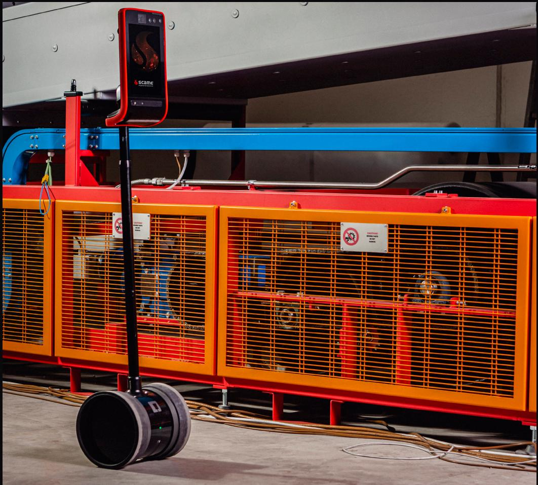
ScameBot è un robot di comunicazione a distanza con movimentazione autonoma a due ruote e completamente da remoto, che consente di collegare il tecnico con l'operatore/addetto di manutenzione del cliente - ovunque esso si trovi - e consentire un servizio di DIAGNOSTICA e SUPPORTO come se fosse fisicamente on-site.
